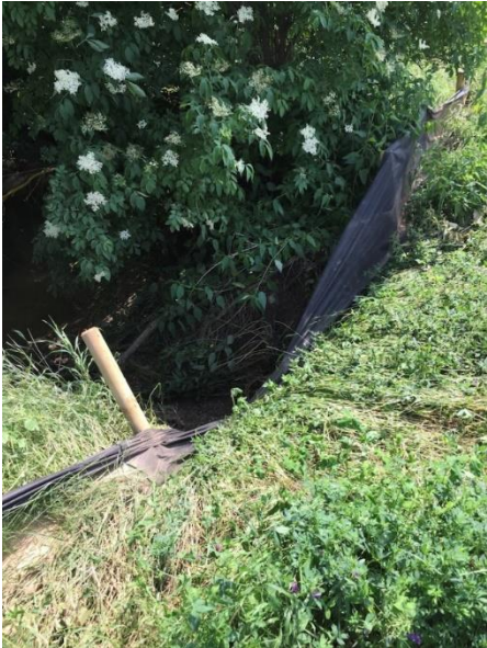
Abb. 67 Ergebnisse zur Sedimentretentionswirkung eines Sedimentauffangzaunes. Der Zaun wurde durch ein Oberflächenabflussereignis nach einem Niederschlagsereignis am 1.6.2018 ( 36 \text{ mm/h} ) zerstört. Foto: G. Lützenburg, 2018.
