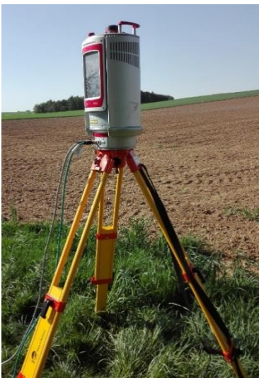
Abb. 7 Auf einem Dreibein installierter RIEGL VZ-6000. Foto: G. Eberhard, 2018.
